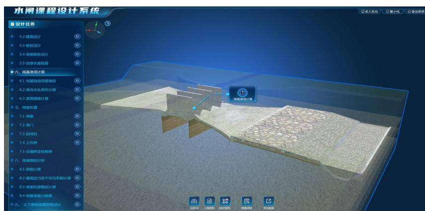
渗流计算的目的在于求解渗透压力、渗透坡降，并验算地基土在初步拟定的地下轮廓线下的抗渗稳定性。常用的渗流计算方法有流网法和改进阻力系数法；对于地下轮廓线比较简单，地基又不复杂的中、小型工程，可考虑采用直线比例法，对于大型水闸一般采用改进系数法。
