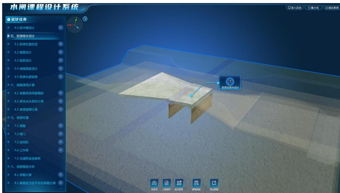
防渗及排水设计的主要内容包括：地下轮廓线布置、铺盖设计、板桩设计、室底板设计、防渗长度验算。
