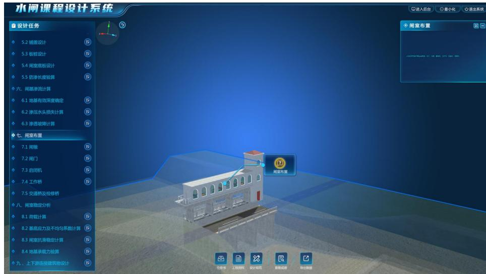
水闸闸室布置内容主要包括:闸门、闸墩、启闭机、工作桥、交通桥、检修桥。
