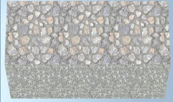
海漫起始水平段一般长5~10m，其顶面高程可与护坦齐平或在消力池尾坎顶以下0.5m左右，水平段后面的斜坡宜做成等于或缓余1:10。一般在前段约1/4段通常采用浆砌块石或混凝土结构，余下的后段常用干砌石结构。海漫底部应铺设砂砾、碎石垫层，以防止底流淘刷河床和被渗流带走基土，垫层厚度一般100~150mm。
