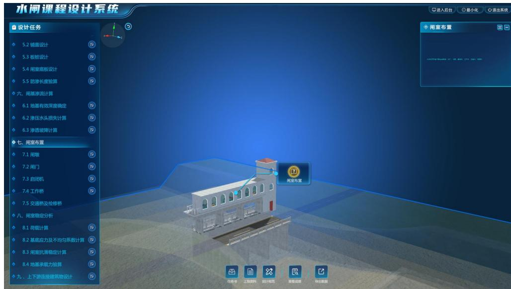
闸室稳定分析内容主要包括：荷载计算、基底应力及不均匀系数计算、抗滑稳定计算、地基承载力计算。
