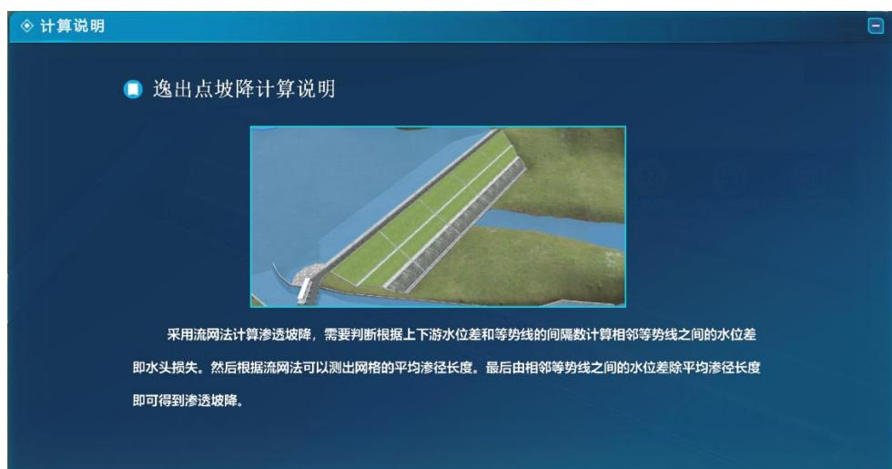
(2) 溢出点渗透坡降计算：正常蓄水位渗透坡降(*i*)、设计洪水位渗透坡降(*i*)、校核洪水位渗透坡降(*i*)
