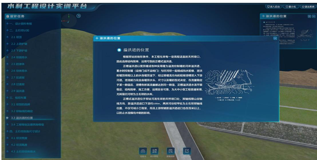
根据坝址的地形条件,本工程左岸有一定高程适宜的天然垭口,因此选择结构简单、运用可靠的正槽式溢洪道。
