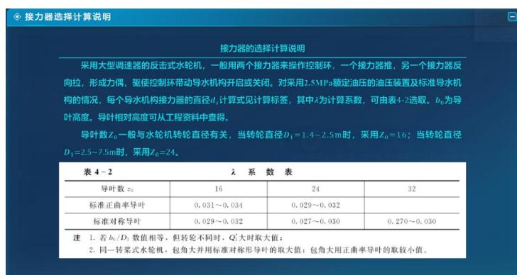
(2) 接力器直径计算参数：接力器直径 (mm)，点击编辑框或图标查看接力器直径计算介绍内容。
