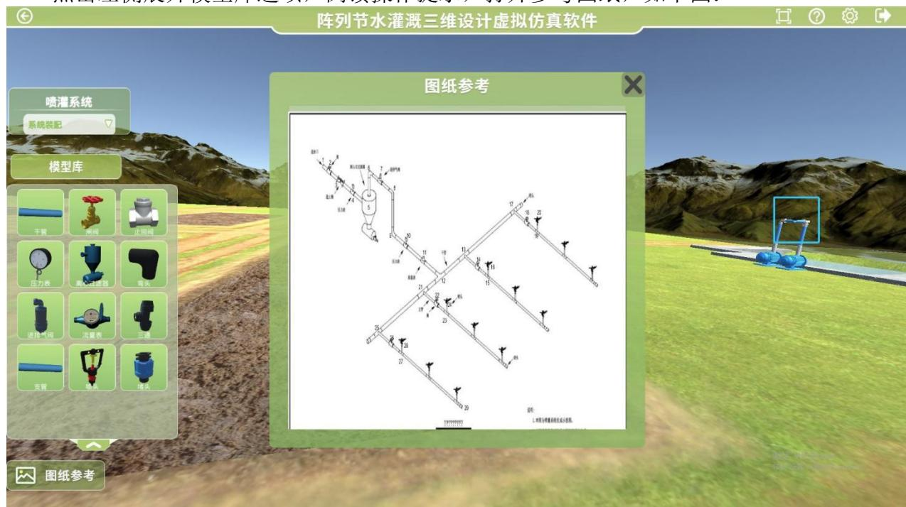
将模型库中的组件按照参考图纸中的顺序拖动至右侧进水口高亮处，完成系统装配，操作错误三次，将出现提示，如下图：
