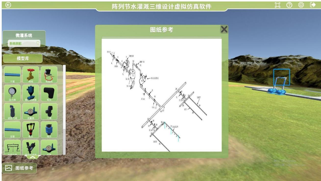
将模型库中的组件按照参考图纸中的顺序拖动至右侧进水口高亮处，完成系统装配，操作错误三次，将出现提示，如下图：
