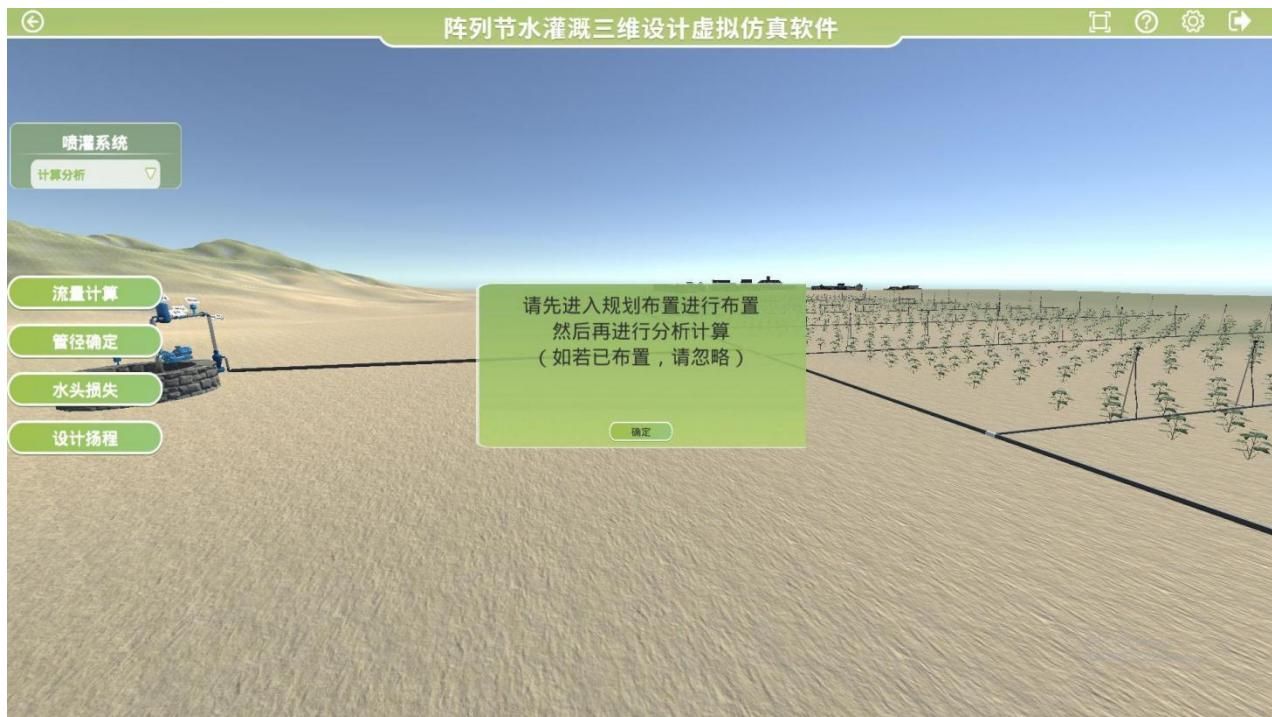
点击左侧流量计算选项，学习流量计算公式，输入相关参数，点击右下角计算器状按钮，完成支管流量计算，如下图：
