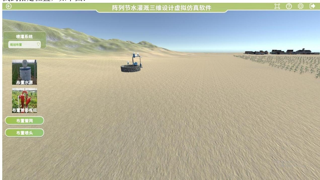
点击布置管网，学习管网计算公式，输入相关参数，完成后点击右下角计算器状按钮，完成管网布置，如下图：
