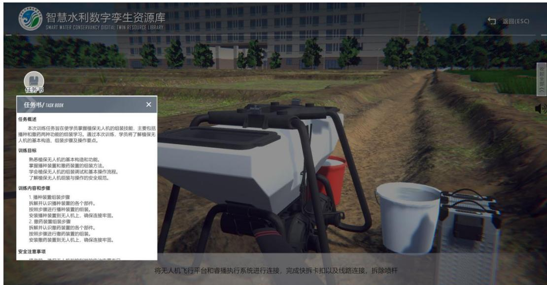
通过虚拟操作界面和任务式学习模块，让学习者掌握植保无人机的组装技能，主要包括播种和撒药两种功能的组装学习。通过本次训练，学员将了解植保无人机的基本构造、组装步骤及操作要点。
