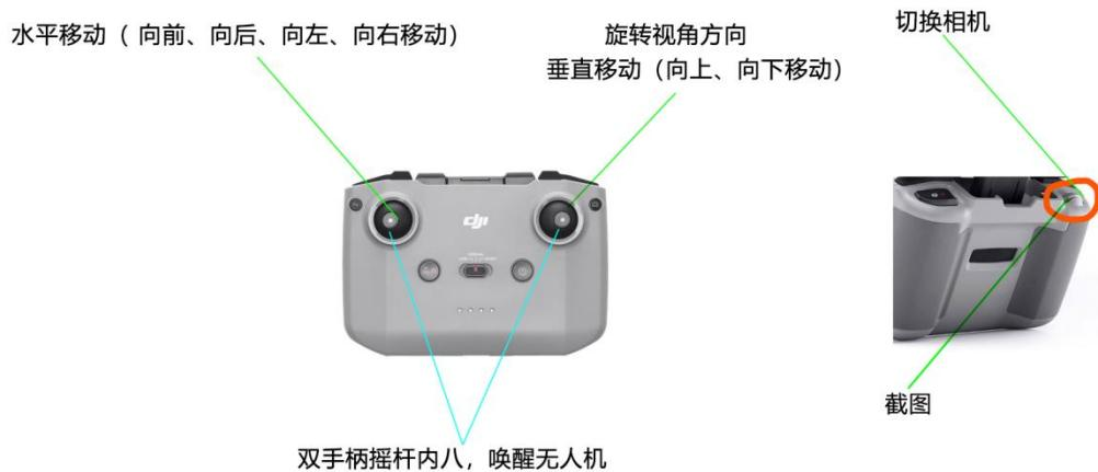
遥控器摇杆双内八唤醒无人机，左侧摇杆控制向前、向后、向左、向右水平移动，右侧摇杆旋转视角方向，向上、向下垂直移动。左上方滚轮向左滚动切换相机、向右滚动截图。
